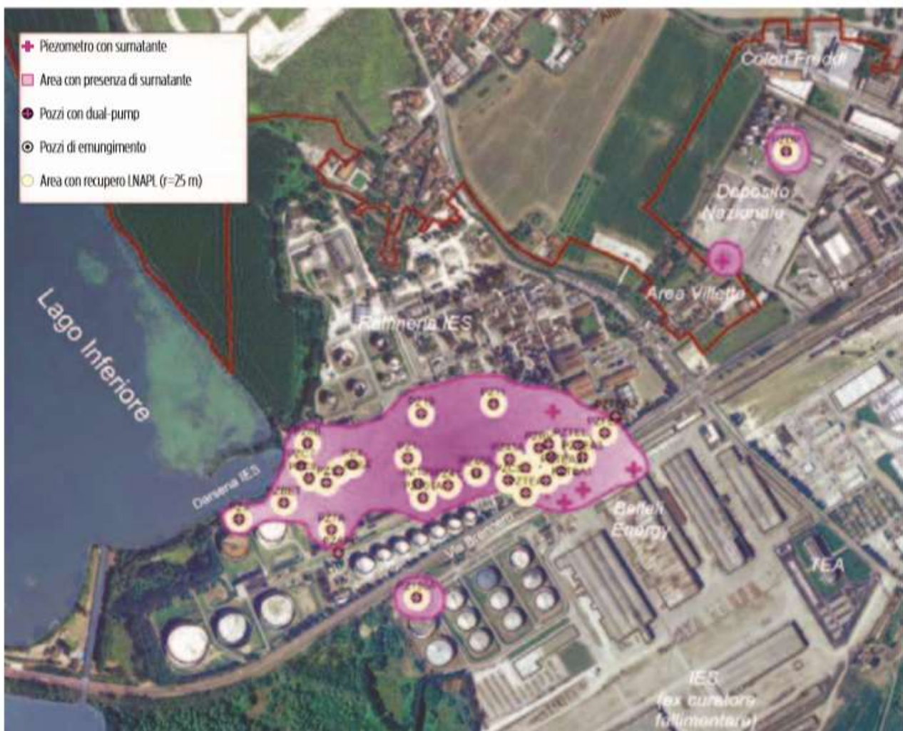
Figura 16. Distribuzione del urnatante presso la raffineria IES di Mantova, giugno, 2009. La crocetta rosa – piezometro con surnatante, colore rosa – area con presenza di surnatante (1)
