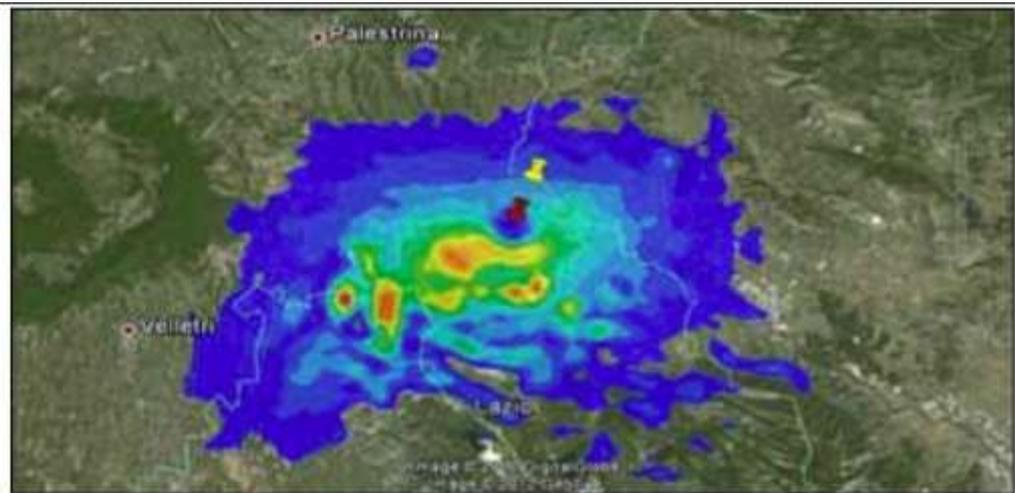
Figura 11. Impronta del termovalorizzatore di Colferro. Concentrazioni di PM10 stimate dal modello di dispersione, ERAS, 31.07.2012. (53)
