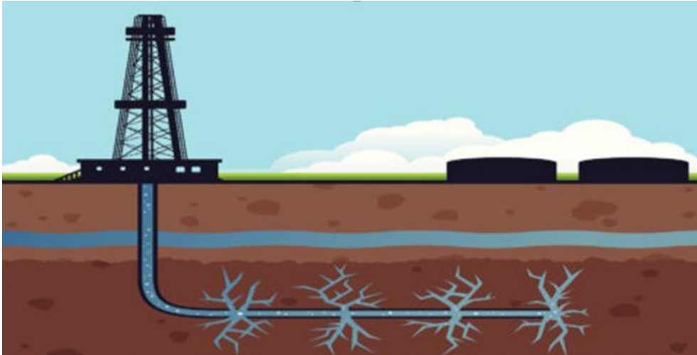
Рисунок 30. Фрекинг с образованием “радиальных трещин”. (69)
