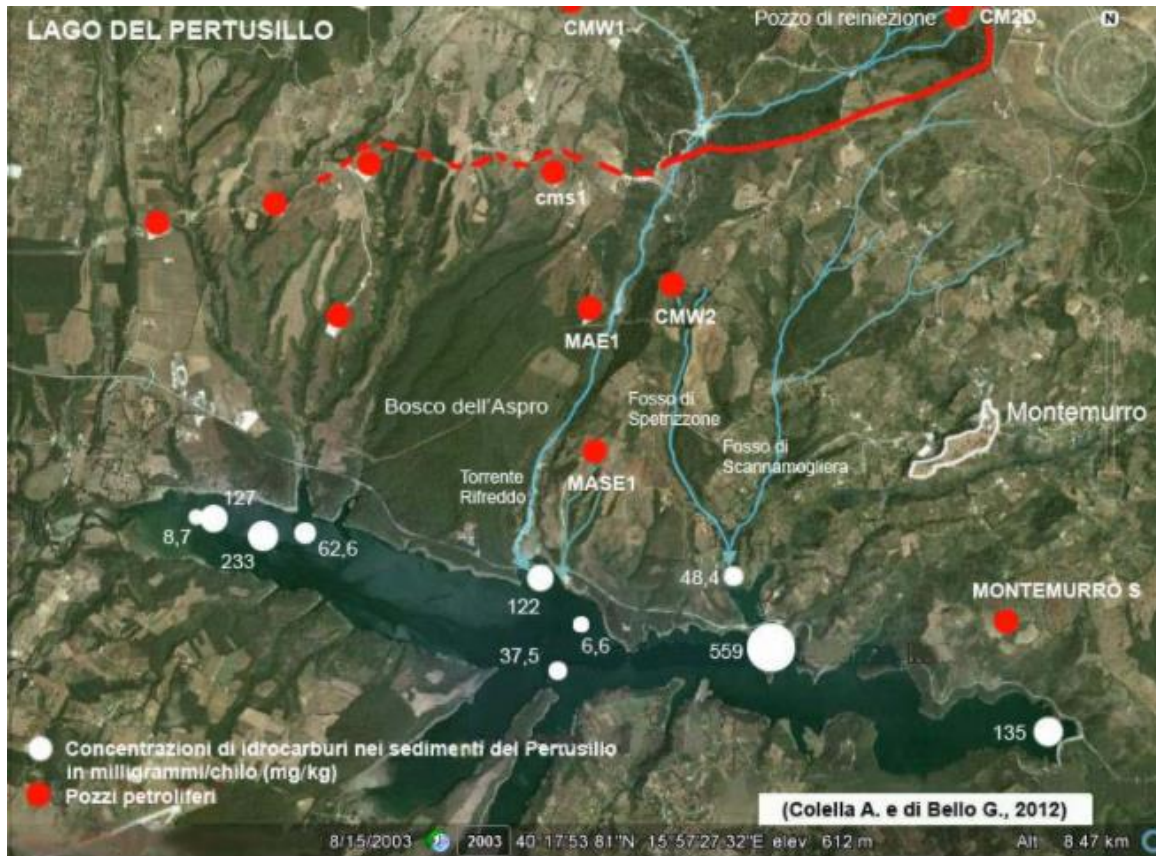
Рисунок 37. Концентрация углеводородов в донных отложениях Озера Пертусилло, мг/кг. Легенда: нефтяные скважины (красный), реки (синий), углеводороды (белый). Колелла А., Ди Белло Дж., 2012 г. (124)
