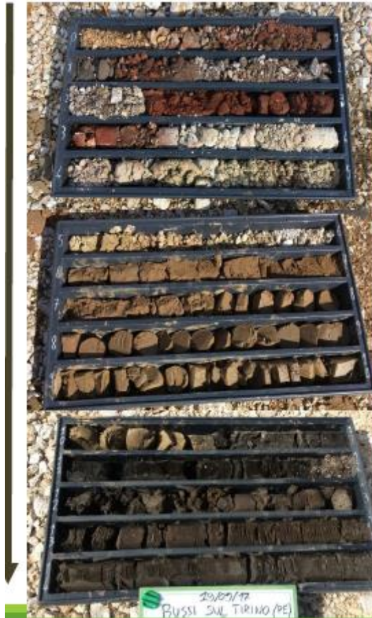
Рисунок 9. Свалка Тре Монти , отходы (вплоть до 7 м), загрязненные насыщенные болотные отложения (вплоть до 16 м) и отложения ненасыщенные (вплоть до 20 м) (21)
