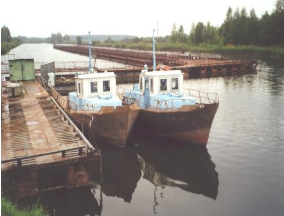
Рис. 14. Понтоны для выращивания карпа в теплом канале Белоозерской ГРЭС, Беларусь
