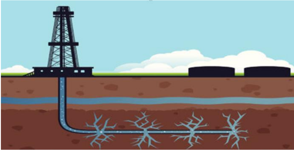
Рисунок 30. Фрекинг с образованием “радиальных трещин”. (69)
